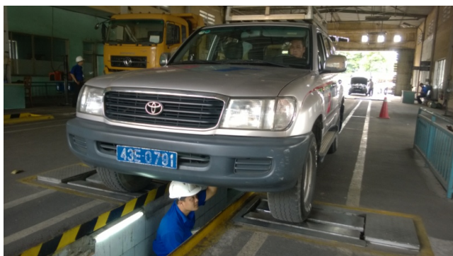
Kiểm tra hệ thống chuyên hỏng xe
