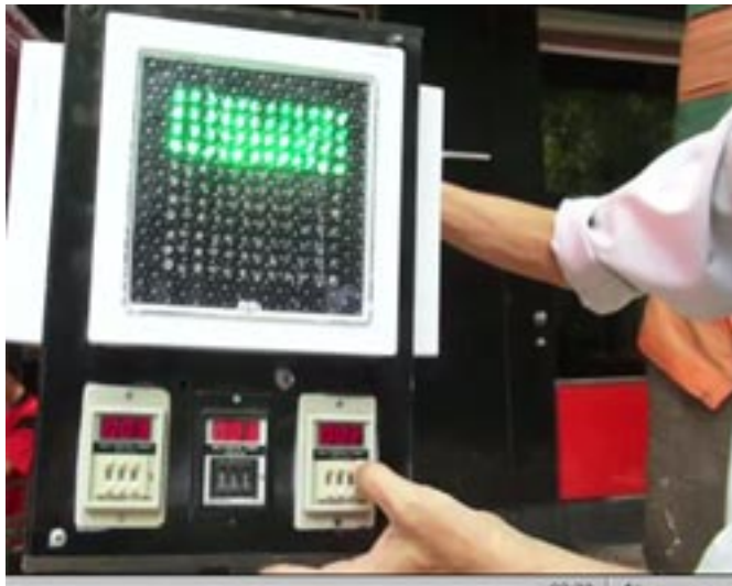
Chiếc đèn giao thông thông minh có thể dùng tay điều khiển
