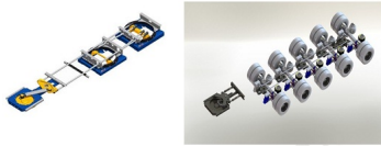
Hình 19. Hệ thống lái bằng thủy lực và thanh đòn.
